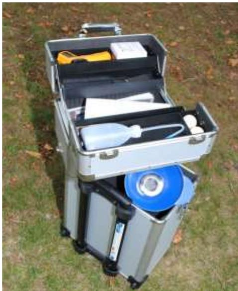
Mithilfe eines Bodenkoffers können sie nun in 10 Stationen am eigenen Ackerboden physikalische, chemische und biologische Faktoren beurteilen, und so die jeweiligen Bedürfnisse des Bodens feststellen. Alle Werte können mit Hilfe einer App am Handy digital erfasst werden. Die Auswertung bekommt man bequem als E-Mail nach Hause gesendet – das ermöglicht eine Langzeitanalyse.
